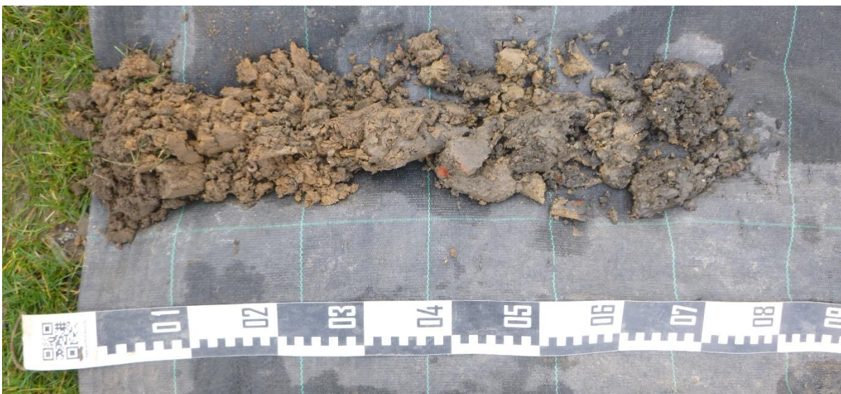
Figuur 40: Overzichtsfoto van boring BP7, uitgelegd van links naar rechts.
