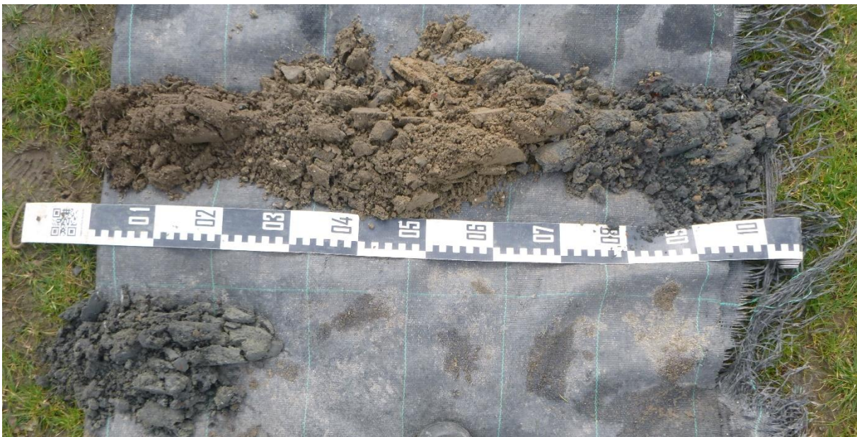
Figuur 36: Overzichtsfoto van boring BP4, uitgelegd van links naar rechts en van boven naar onder.
