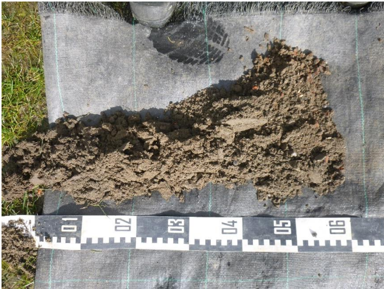
Figuur 38: Overzichtsfoto van boring BP2, uitgelegd van links naar rechts.
