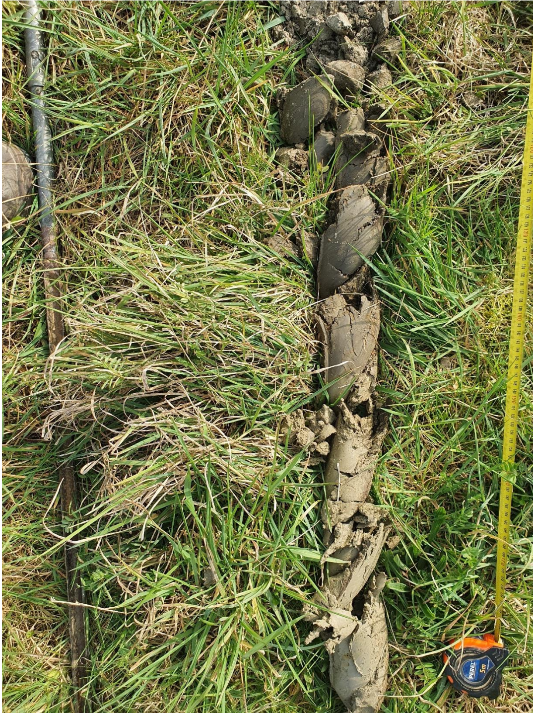
Figuur 2: representatief boorprofiel (B1) van een AC-horizont met onderliggende verweerde getijdenafzettingen.
