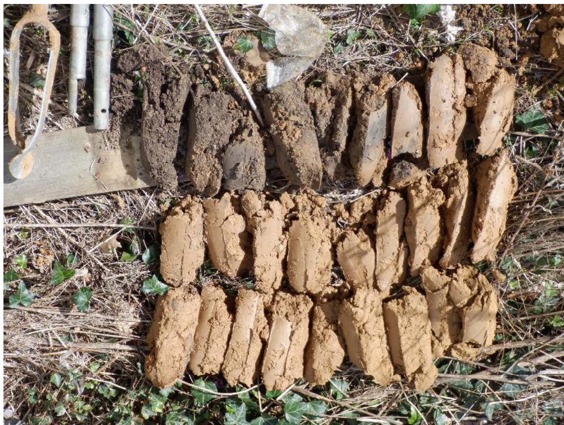
Afbeelding 4.3: Opgeboorde boorkernen van boring 6 beginnend vanaf linksboven naar rechtsonder.
