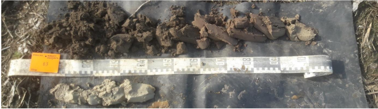
Figuur 10 : Boring 3, van 0 (linksboven) naar 140 cm (midden onder) beneden het maaiveld.
