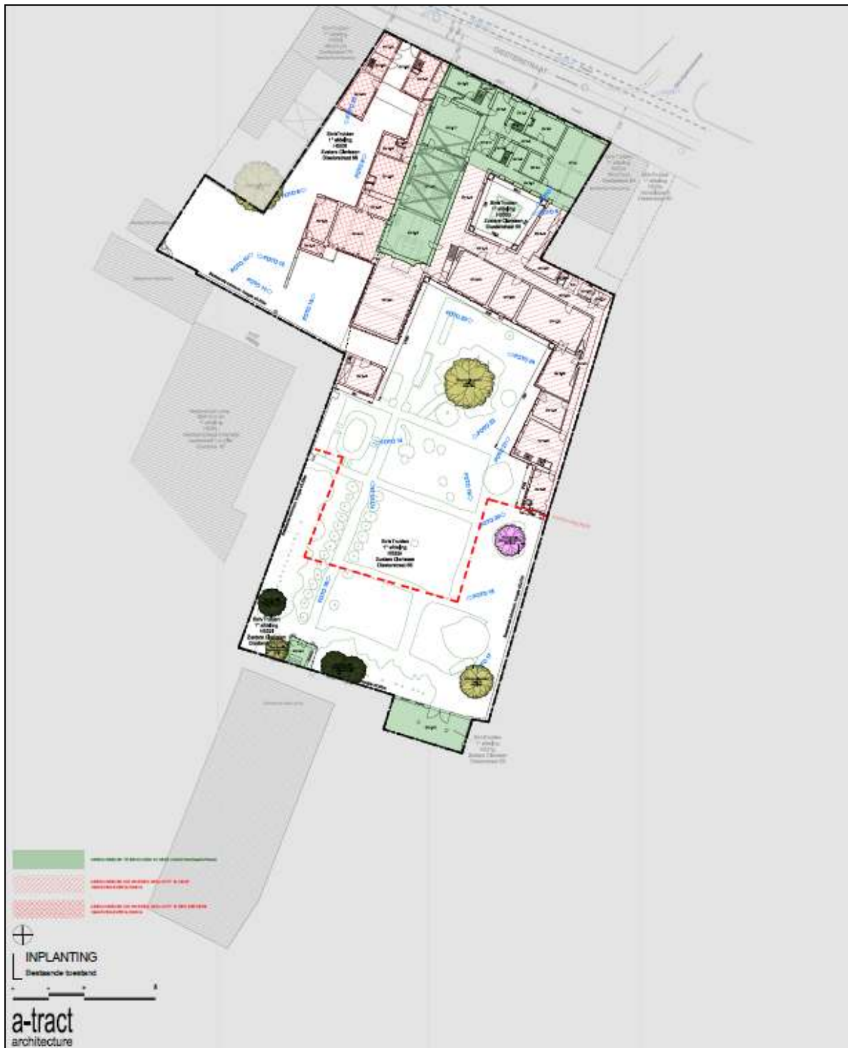
Afb. 3: Inplantingsplan bestaande toestand met aanduiding van de te behouden bebouwing in het groen en met aanduiding in kleur van de te behouden bomen. De te slopen bebouwing is in het rood gearceerd. De geblokte arcering behoort tot een eerdere omgevingsvergunning (perceel 503f) (Bron: a-tract architecture, digitaal plan, dd .07/05/2020, aanmaatschaal onbekend, 2020D258).
