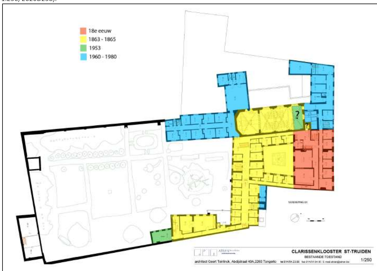
Afb. 32: Opmetingsplan verdieping met aanduiding bouwfases (© Atran cvba, digitaal plan, dd onbekend, aanmaatschaal 1.250, 2020D258).
