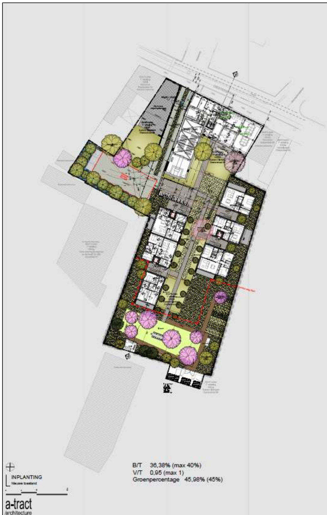
Afb. 4: Inplantingsplan ontworpen toestand met het noordwestelijk, reeds vergunde terreindeel in het grijs gearceerd (Bron: a-tract architecture, digitaal plan, dd .onbekend, aanmaakschaal onbekend, 2020D258).
