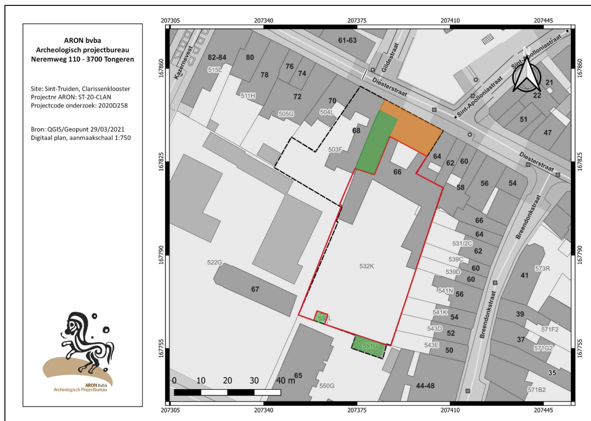
Afb. 40: Kadastraal plan met perceelgrenzen en afbakening van de zones met de impact van de werken; groen: geen impact, oranje: zone opbraak vloer; rood: grote impact.
