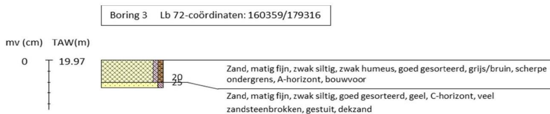
Figuur 12: Boorstaat boring 3.
