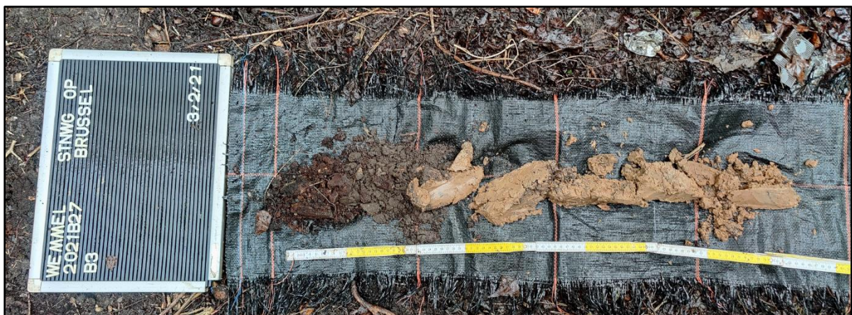
Figuur 12: Foto van het bodemprofiel bij boring 3 met de afwijkende A-Aan-C bodemsequentie (ABO nv 2021)
