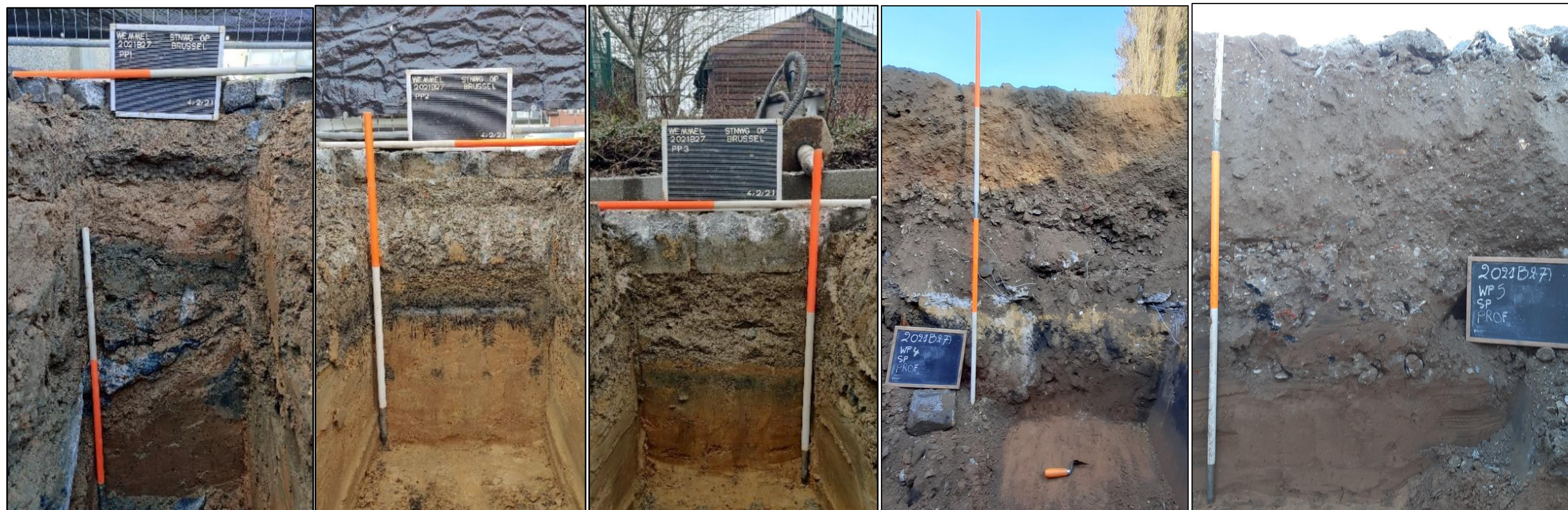
Figuur 13: Foto van de bodemverstoring waargenomen in de profielputten (PP1-5 van links naar rechts) (ABOnv 2021)
