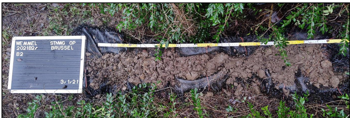
Figuur 11: Foto van het bodemprofiel bij boring 2 met de typische A-C bodemsequentie (ABO nv 2021)
