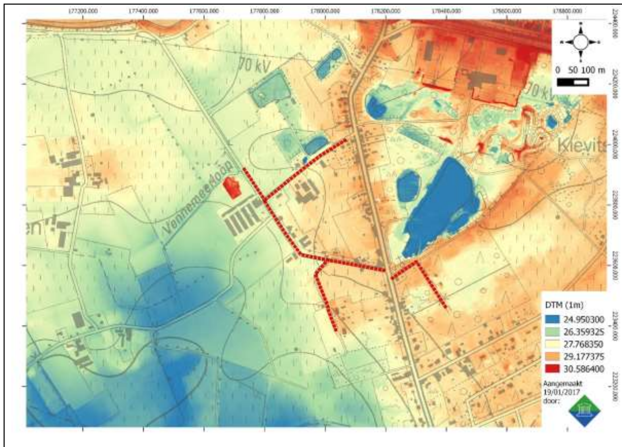
Figuur 6: Digitaal Hoogtemodel (DTM, 1m) met weergave van het tracé (rood) (bron: geopunt 2016).
