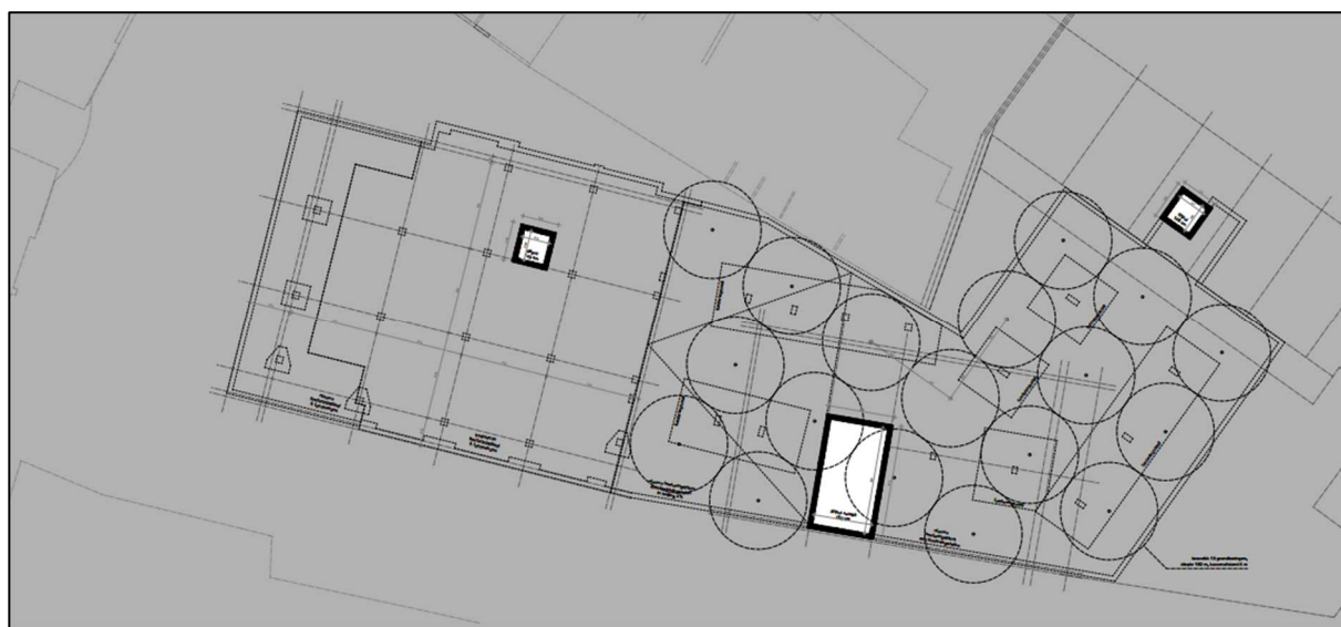
Figuur 14: Funderingsplan en grondboringen. 24
