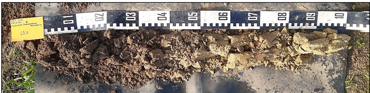
Figuur 13: Boring 1 van 0 (links) tot 100 cm (rechts) onder het maaiveld.
