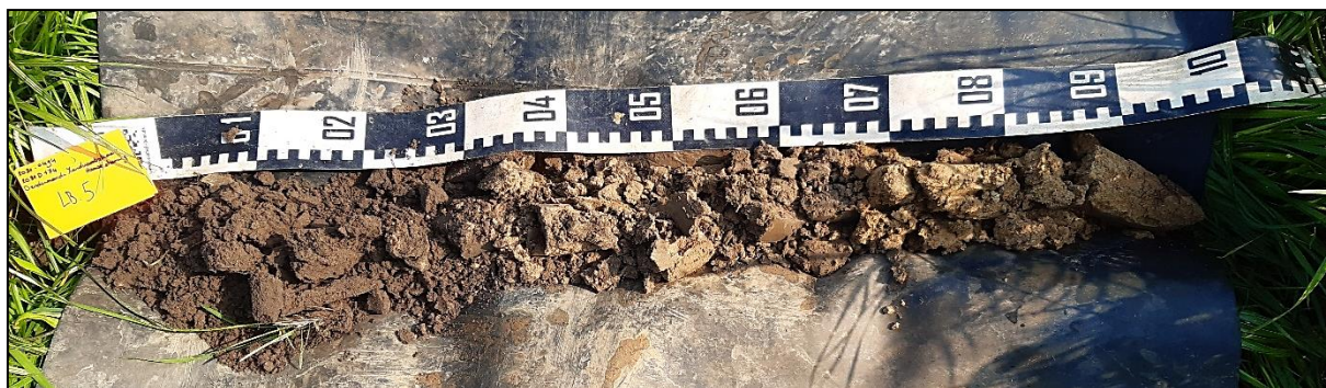
Figuur 17: Boring 5 van 0 (links) tot 100 cm (rechts) onder het maaiveld.
