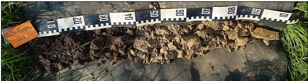
Figuur 14: Boring 2 van 0 (links) tot 100 cm (rechts) onder het maaiveld.
