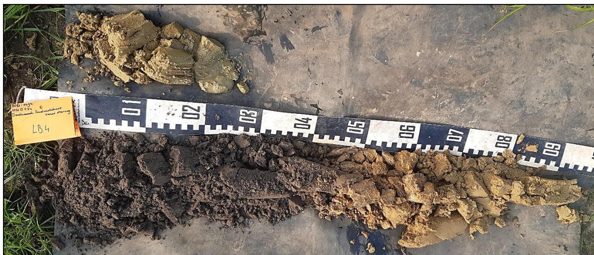
Figuur 16: Boring 4 van 0 (linksonder) tot 120 cm (linksboven) onder het maaiveld.
