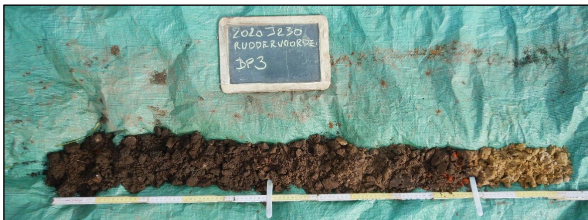
Figuur 14 Boorprofiel 3 A(p)-Verstoring-C opbouw.
