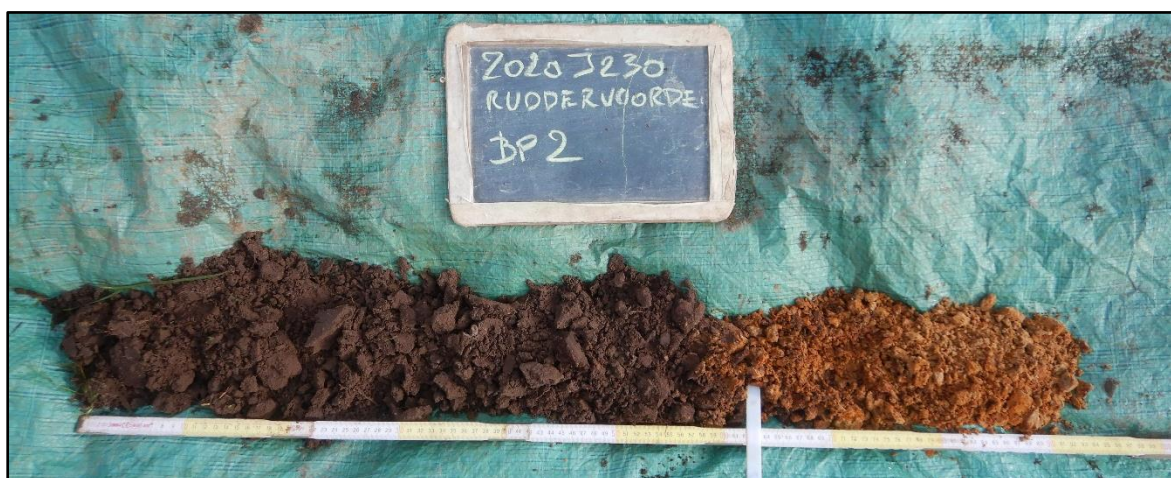
Figuur 13 Boorprofiel 2 met A(p)-C bodemopbouw.
