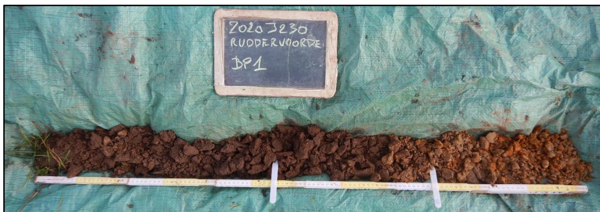
Figuur 12 Boorprofiel 1 met A(p)1 – A(p)2 – C bodemprofiel.
