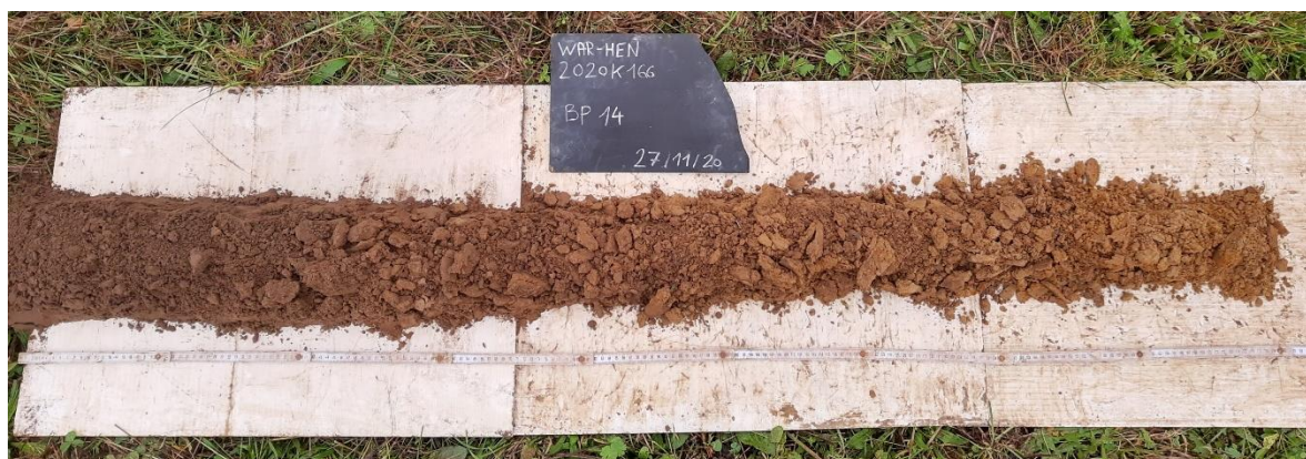
Figuur 4. Representatief boorstaal VAB 14: Ap-Bt-Cg.
