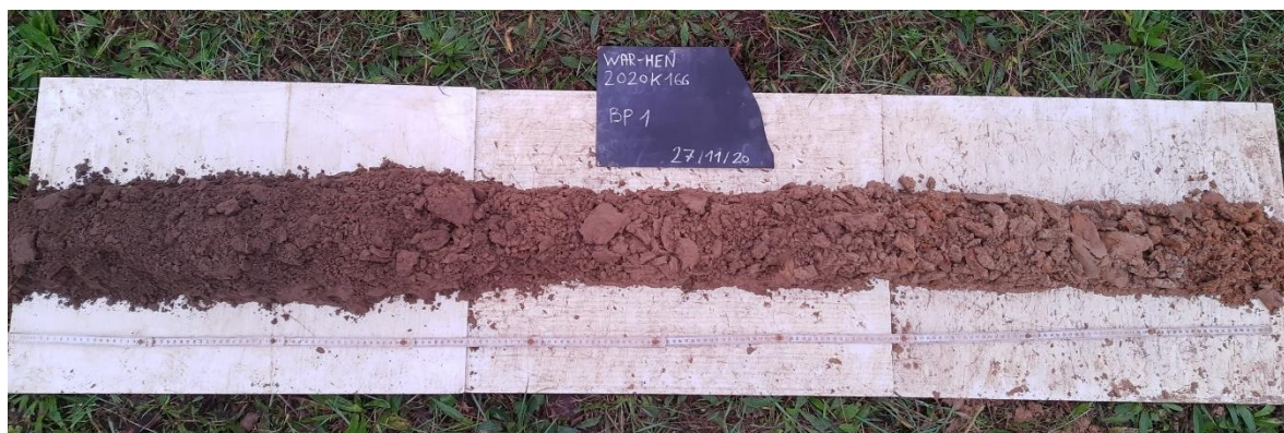
Figuur 3. Representatief boorstaal VAB 1: Ap-Bt-Cg.
