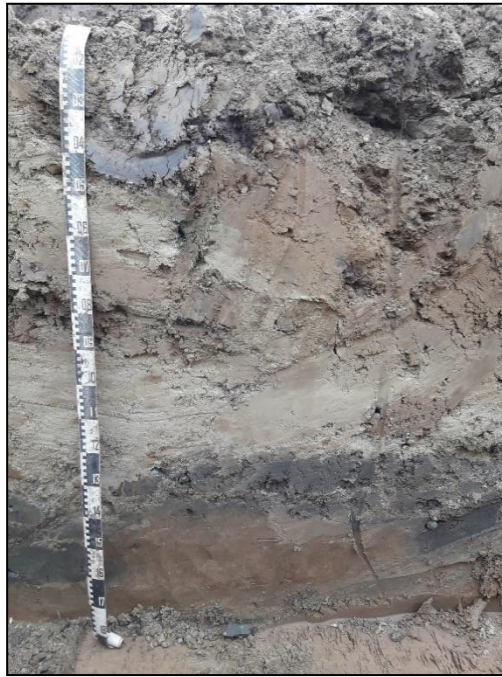
Figuur 11: Profiel 4.1 uit nota Tongeren, Carpoolparking (ID18399) 32 . Onder een ophogingspakket van ca. 150 cm dik komt direct de lemige moederbodem voor.
