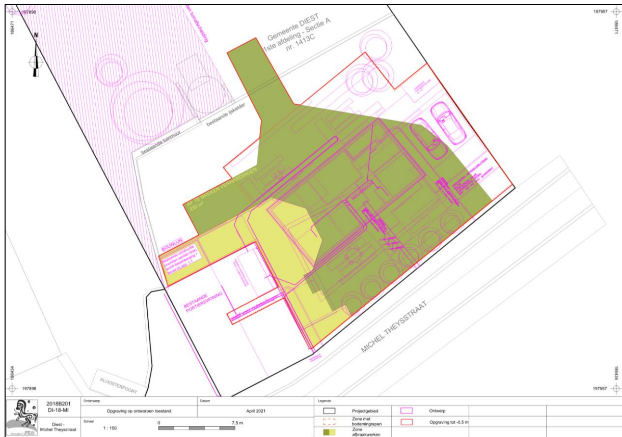
Afb. 25: Ontworpen toestand (paars) en afbraakzones (geel en groen) met aanduiding van de op te graven zone (rood) (Bron: Aron bv, digitaal plan, dd. 30/04/2021, aanmaatschaal 1:150)
