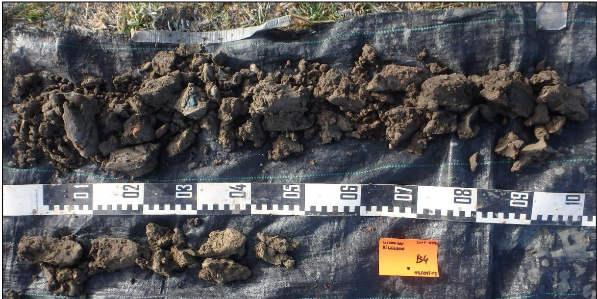
Figuur 35: Boring 4 van 0 (linksboven) tot 150 cm (rechtsonder) beneden maaiveld.
