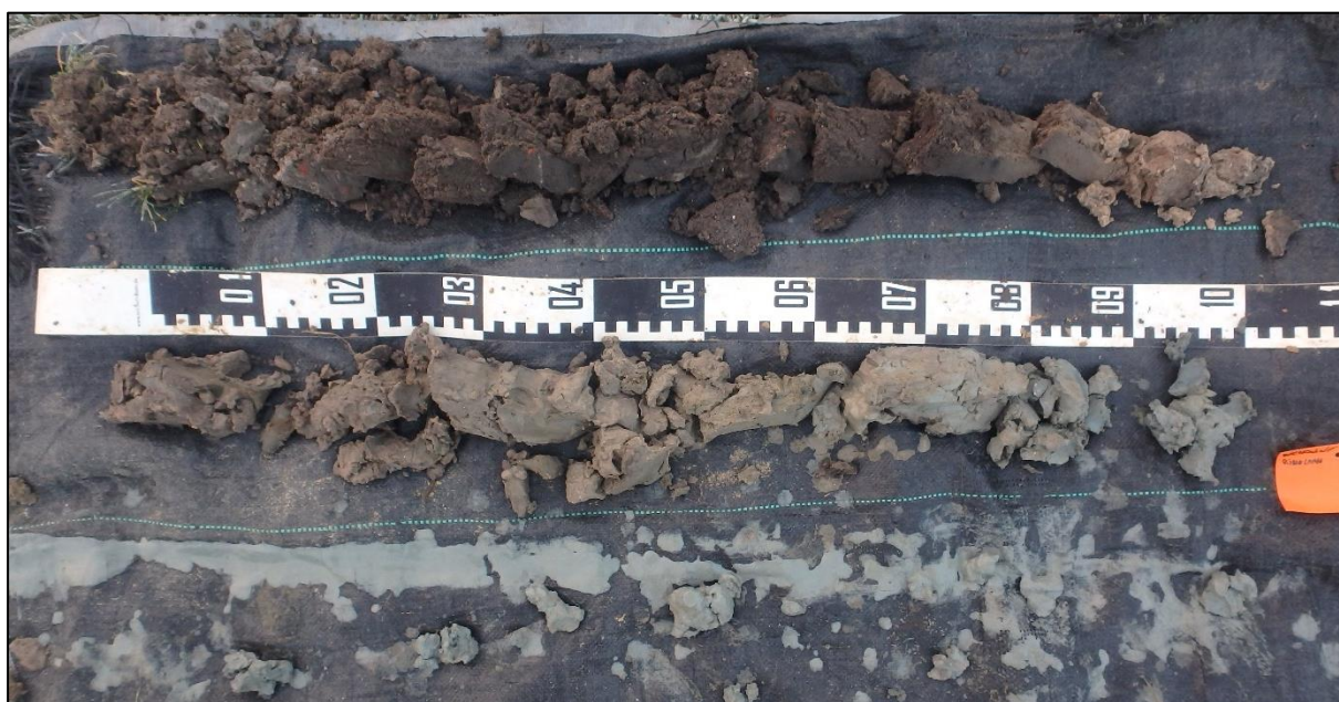
Figuur 32: Boring 1 van 0 (linksboven) tot 300 cm (rechtsonder) beneden maaiveld.
