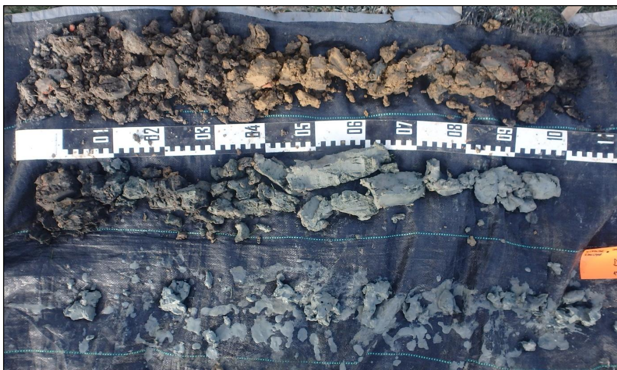
Figuur 34: Boring 3 van 0 (linksboven) tot 300 cm (rechtsonder) beneden maaiveld.
