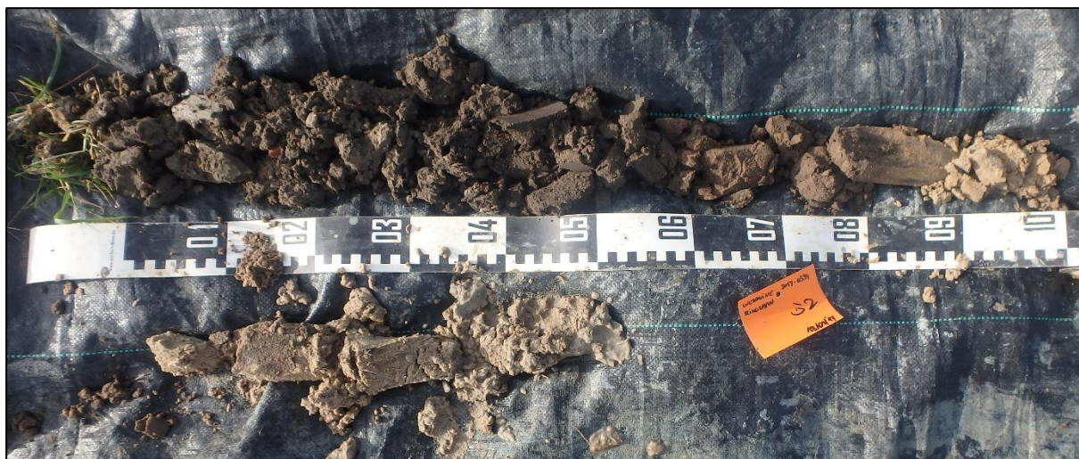
Figuur 33: Boring 2 van 0 (linksboven) tot 150 cm (rechtsonder) beneden maaiveld.
