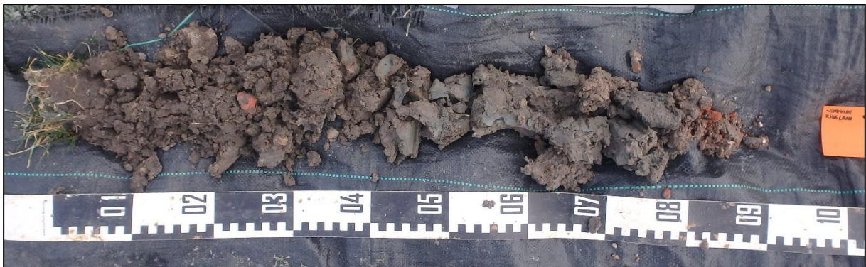
Figuur 36: Boring 5 van 0 (linksboven) tot 80 cm (rechtsonder) beneden maaiveld.
