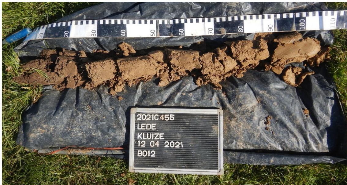
Figuur 16: Boorprofiel 12 met bovenzijde links
