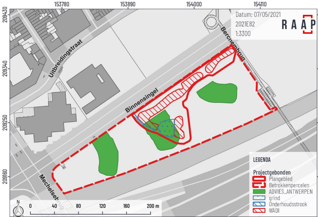
Figuur 2: Overzicht van de geplande bodemingrepen geprojecteerd op de advieskaart van de Stad Antwerpen voor Park Brialmont. (AGIV 2021)
