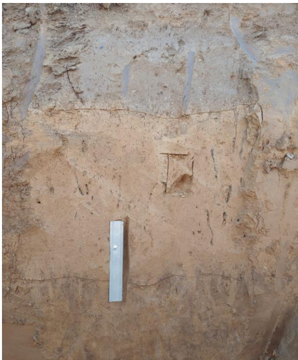
Figuur 28: Detailfoto van bodemprofiel 601 met pollenbak (M1) en aanduiding van de monsterlocatie voor het bulkstaal (M2).
