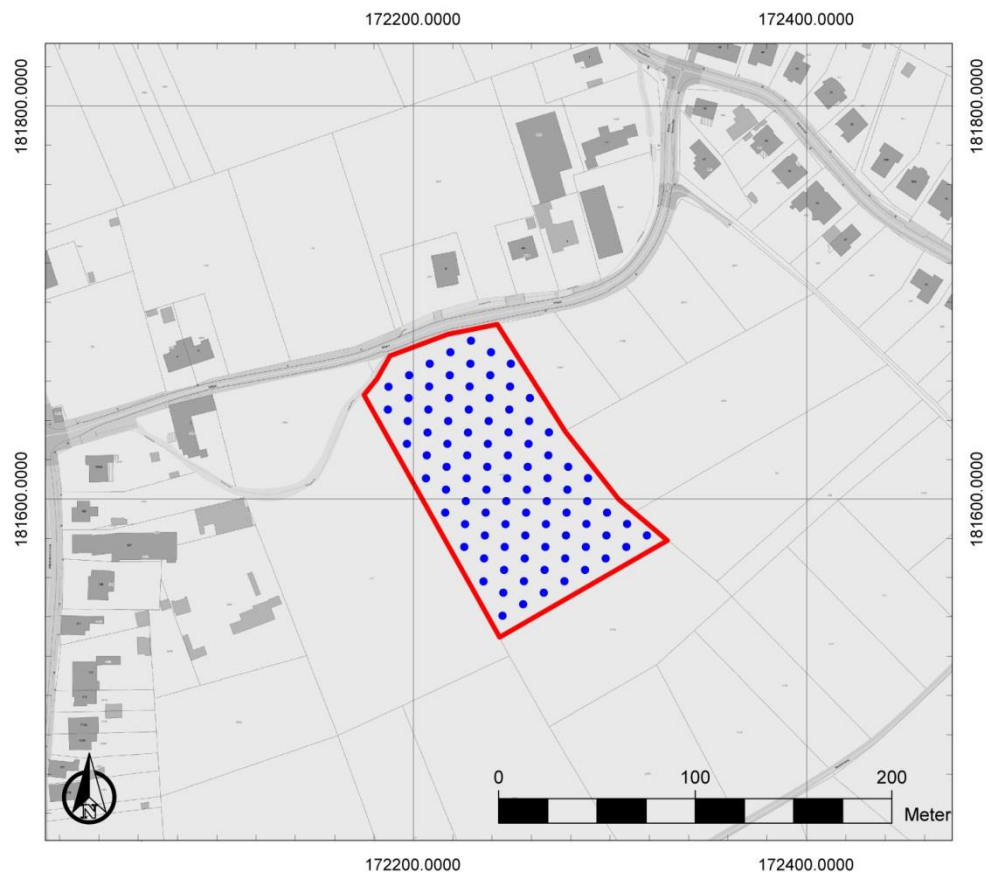
Figuur 5: Inplanting van de verkennende boringen (blauw)
