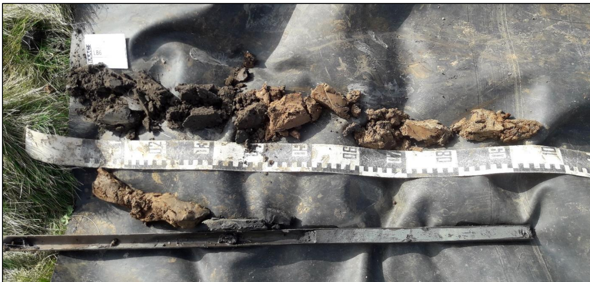
Figuur 3: Voorbeeld van de algemene bodemopbouw binnen de site: Boring 6 werd uitgevoerd tot in de Cr-horizont doormiddel van een gutsboor.
