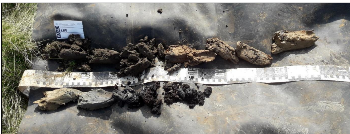
Figuur 4: Voorbeeld van de algemene bodemopbouw binnen de site: Boring 8 bevatte onder een colliviumpakket een horizont met veen.
