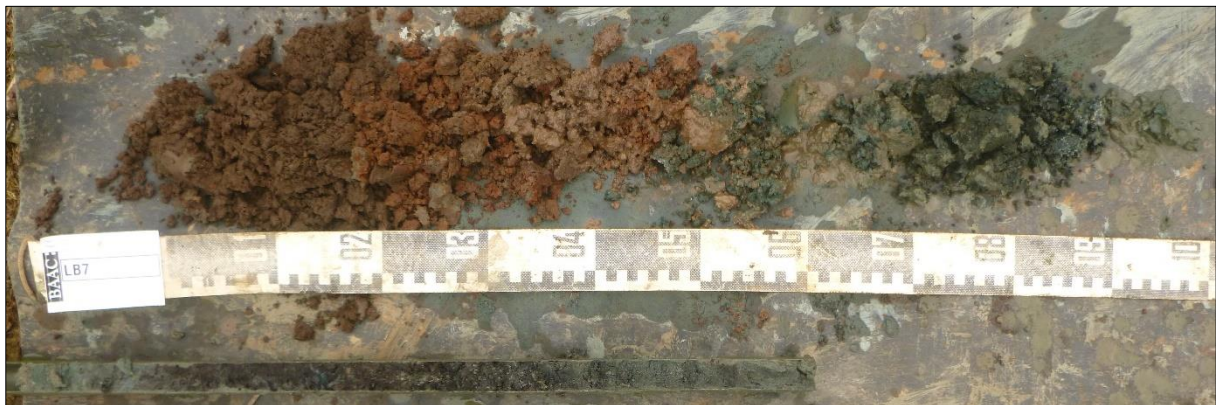
Figuur 9: Boring 7 van 0 cm links boven tot 160 rechts beneden.
