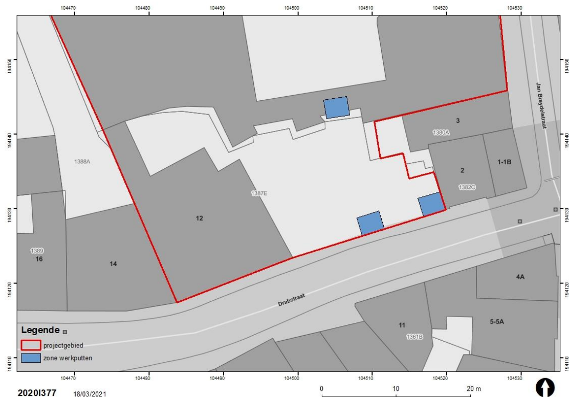
Figuur 6: Inplanting van de drie archeologische werkputten na sloop en voor plaatsen secanspalenwand (Stad Gent, De Zwarte Doos, Stadsarcheologie)
