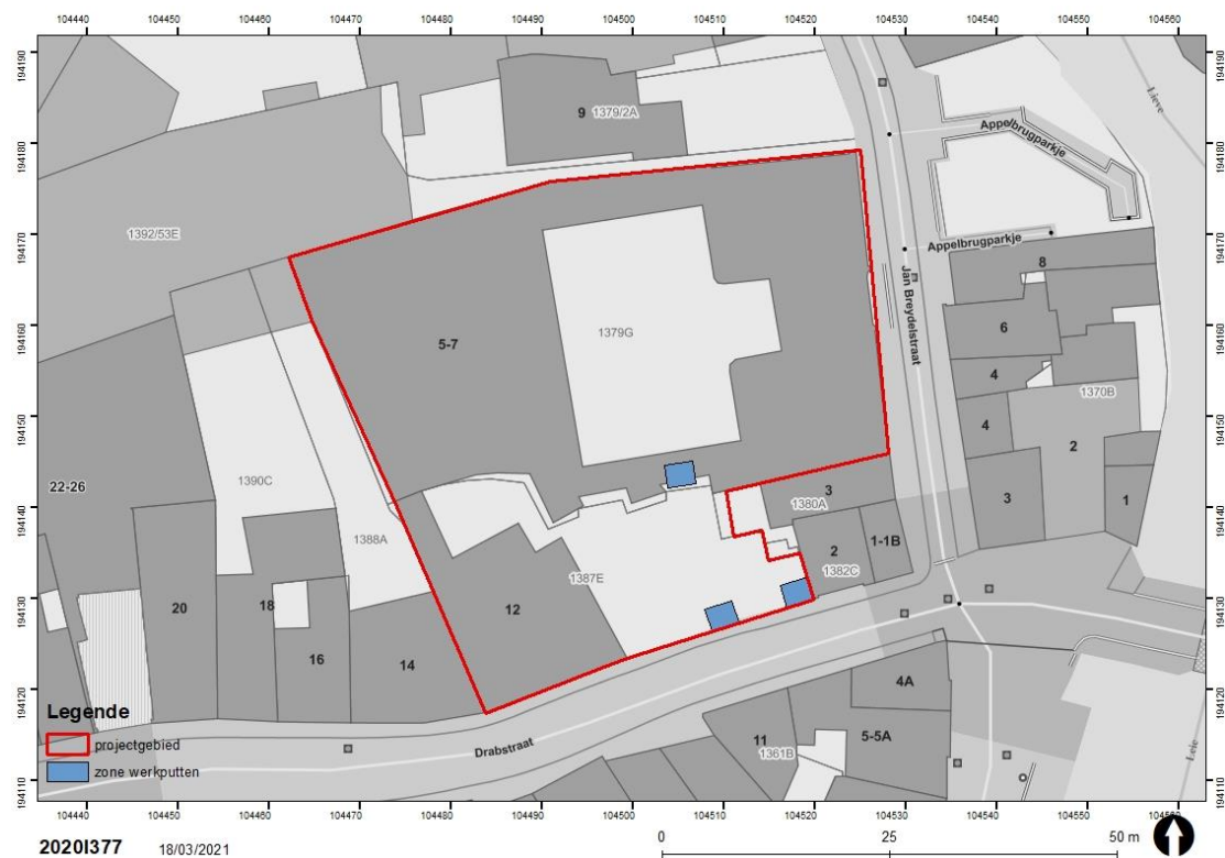
Figuur 40: Inplanting van de archeologische werkputten na de sloop van de bovengrondse structuren en voor het plaatsen van de secanspalenwand (Stad Gent, De Zwarte Doos, Stadsarcheologie)
