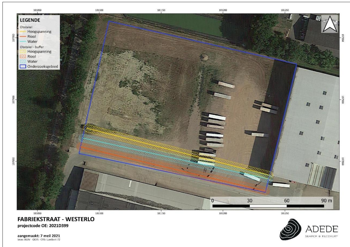
Figuur 10. Aanwezige obstakels op luchtfoto.
