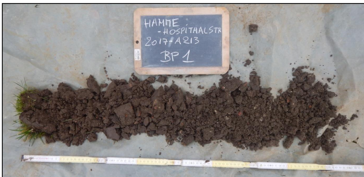
Figuur 19: Zicht op de boorkolom van boorpunt 1, ter hoogte van de Hospitaalstraat, met een volledig verstoorde profielsequentie tot minstens 85cm onder het huidige maaiveldniveau.
