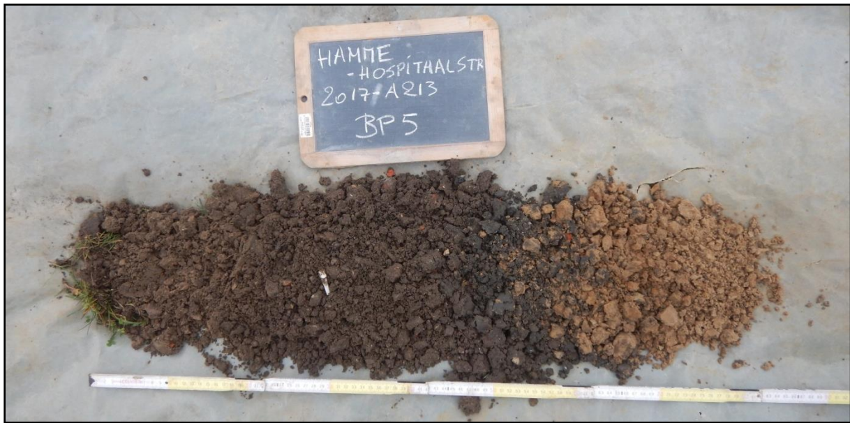
Figuur 20: Zicht op de boorkolom van boorpunt 5 met rechts de geelbruine moederbodem. Boven de moederbodem is een verstoord pakket op te merken met glas, baksteen en kiezels.
