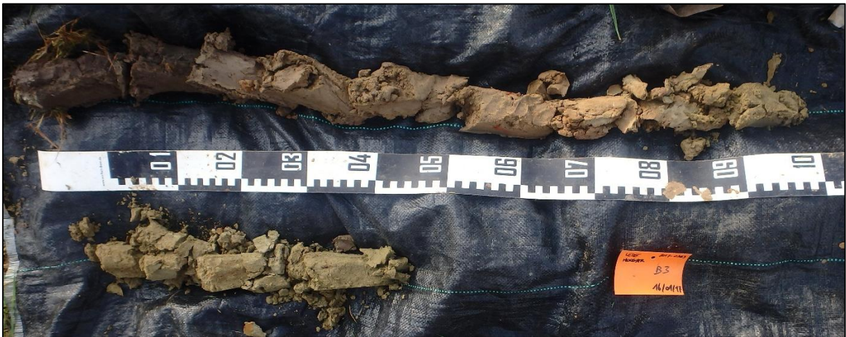
Figuur 30: Boring 3 van 0 (linksboven) tot 145 cm (rechtsonder) beneden maaiveld.
