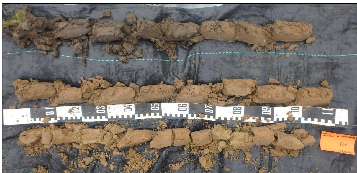
Figuur 28: Boring 1 van 0 (linksboven) tot 300 cm (rechtsonder) beneden maaiveld.
