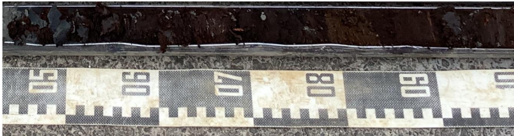
Figuur 26: Detail tweede veenlaag boring B3.
