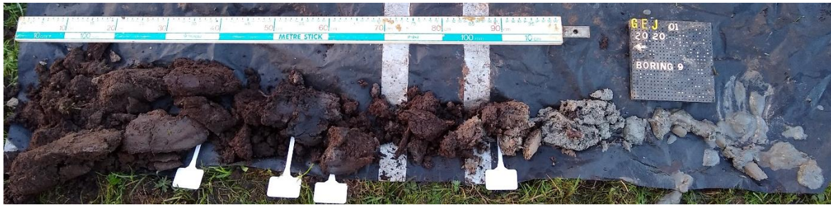
Figuur 43. Boring B9. Witte prikkers tonen laagovergangen aan zoals geïdentificeerd op het veld.
