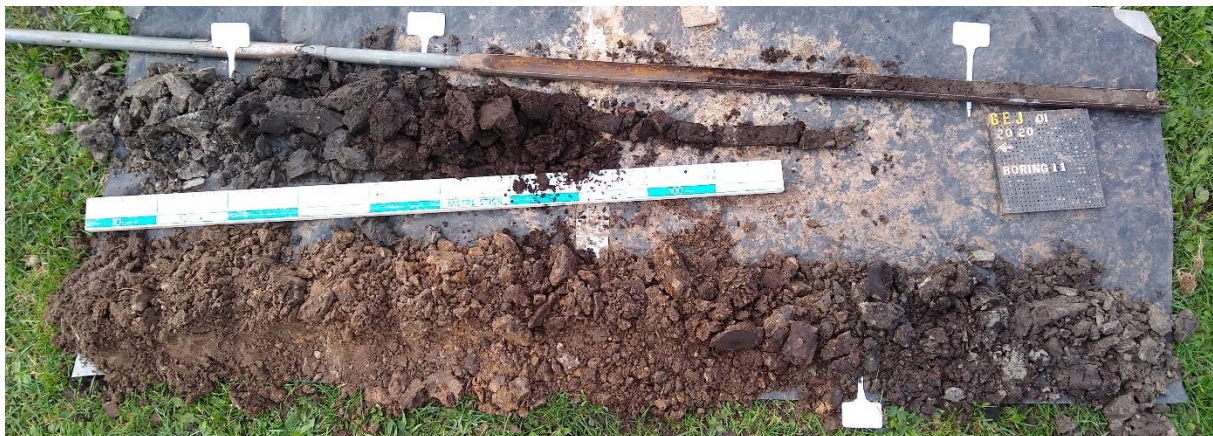
Figuur 47. Boring B11. De prikker rechtsonderaan duidt de overgang tussen de twee types opgevoerde laag aan.
