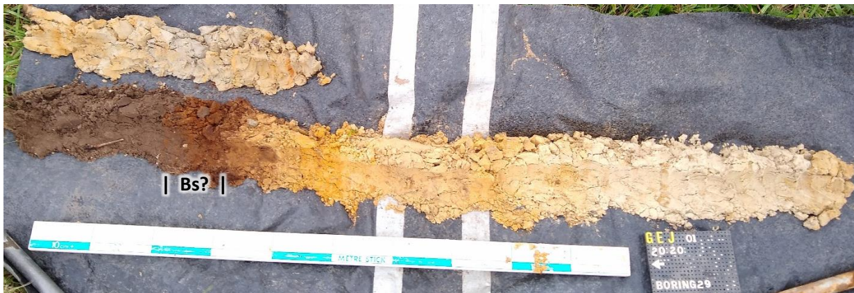
Figuur 51. Boring B29 met typerende bodemopbouw voor de dekzandrug.
