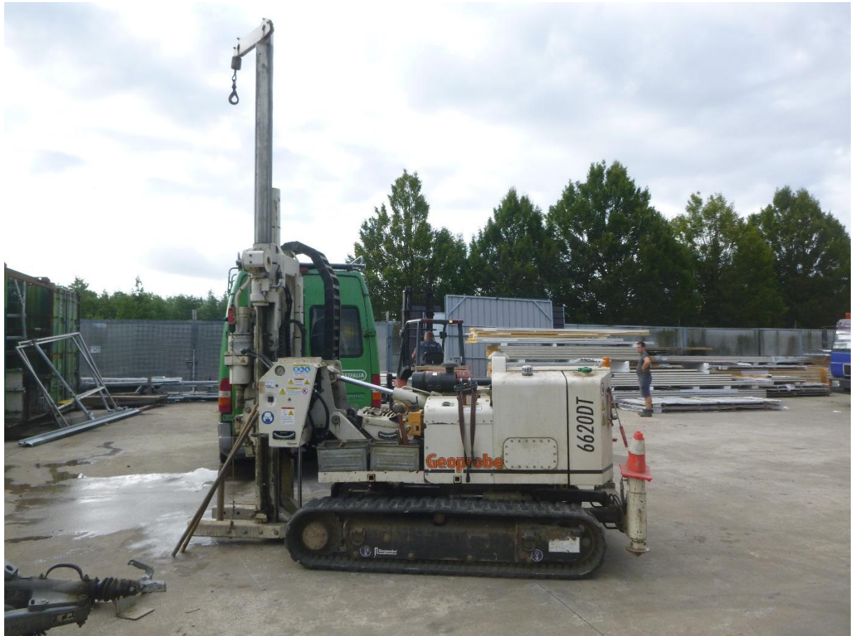
Figuur 13: Zijaanzicht van de gebruikte Geoprobe boormachine.
