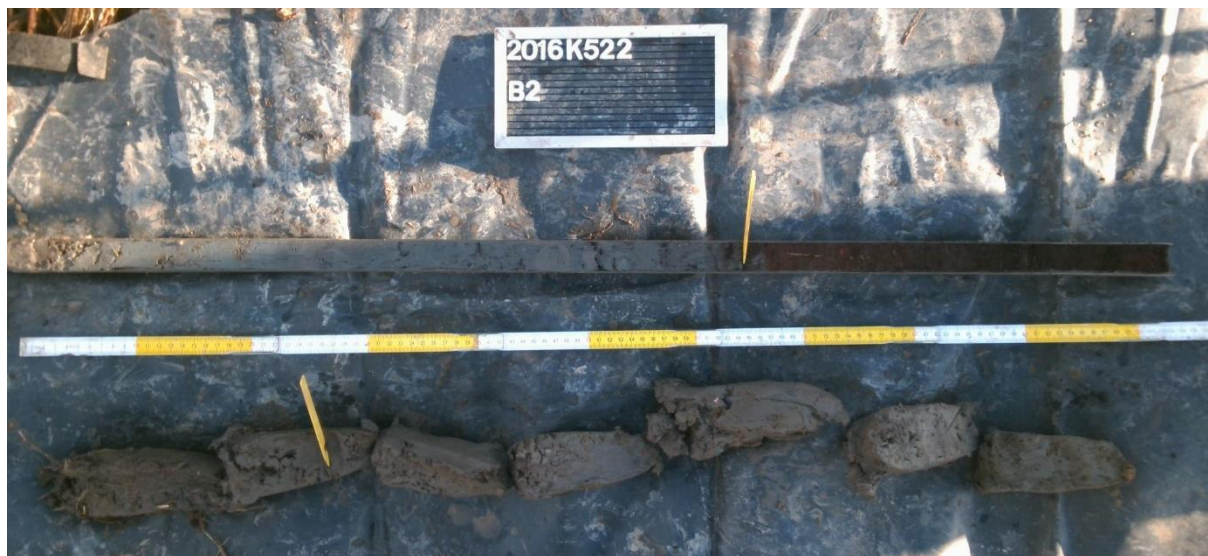
Figuur 23. Boorprofiel B2
