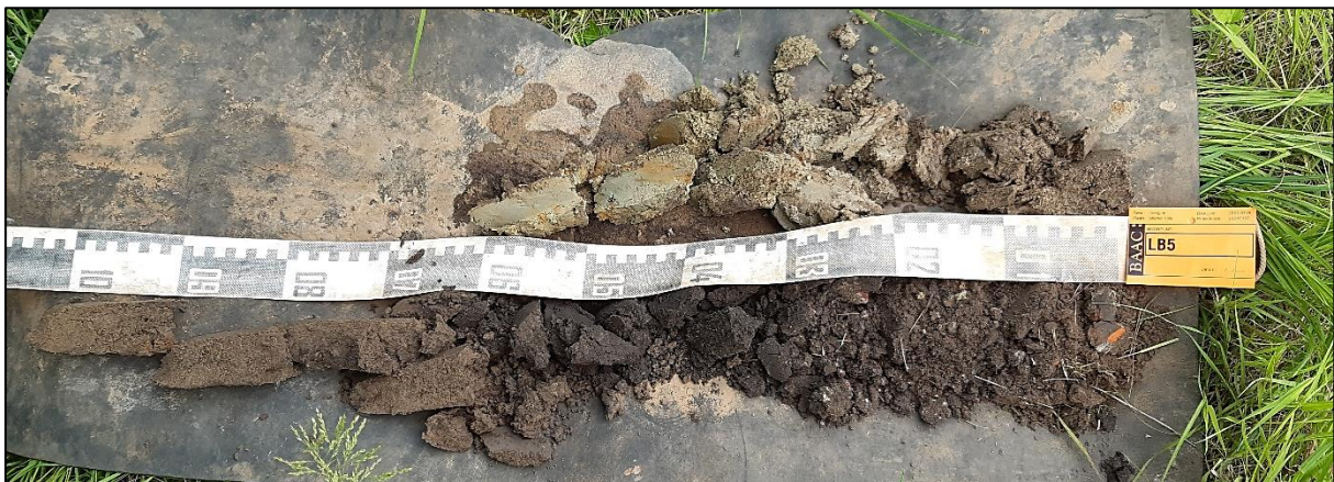
Figuur 13: Boring 5 van 0 (rechtsonder) tot 160 cm (linksboven) onder het maaiveld.
