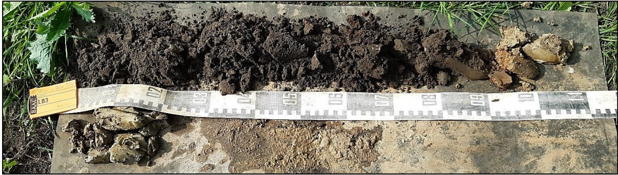
Figuur 11: Boring 1 van 0 (links) tot 120 cm (rechts) onder het maaiveld.
