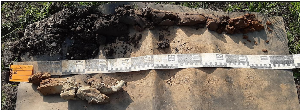
Figuur 10: Boring 2 van 0 (links) tot 140 cm (rechts) onder het maaiveld.
