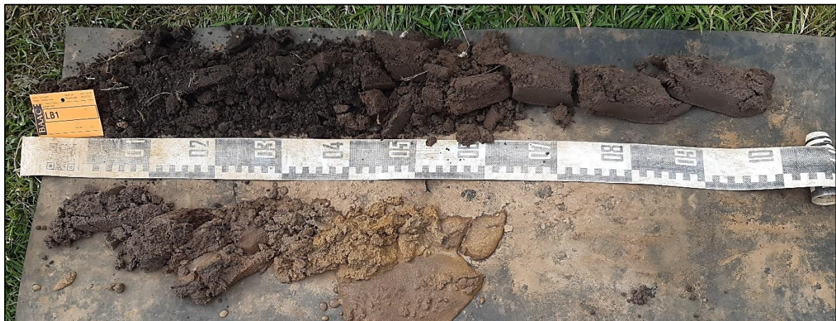
Figuur 9: Boring 1 van 0 (links) tot 150 cm (rechts) onder het maaiveld.
