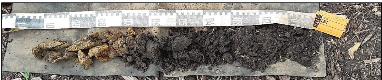
Figuur 12: Boring 1 van 0 (rechts) tot 100 cm (links) onder het maaiveld.
