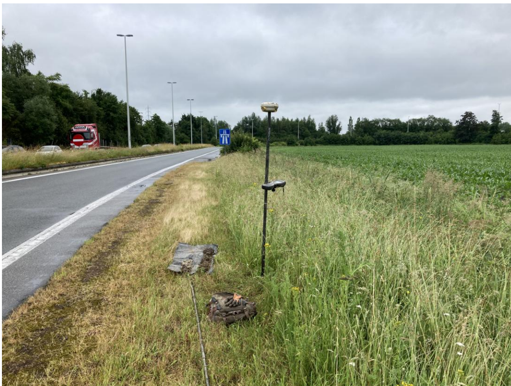
Afb. 11. De boorraai (7 tot 9) aan de oprit van de R4 in het oostelijke deel van het onderzoeksgebied. De GPS geeft de locatie van boring 7 aan. Hier bleek het verharde oppervlak van de weg breder en loopt ca. 1.5 m door onder het gras/mos van de berm, tot aan de gracht (opname 21 juni 2021).
