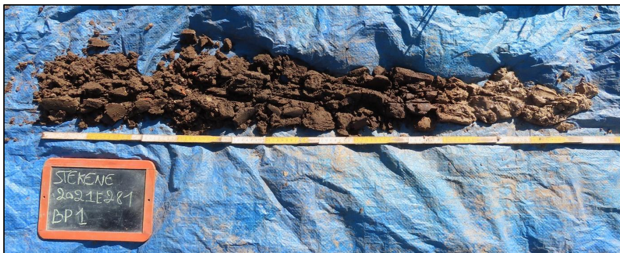
Figuur 6 Boorprofiel 1 met Ap – C bodemprofiel.
