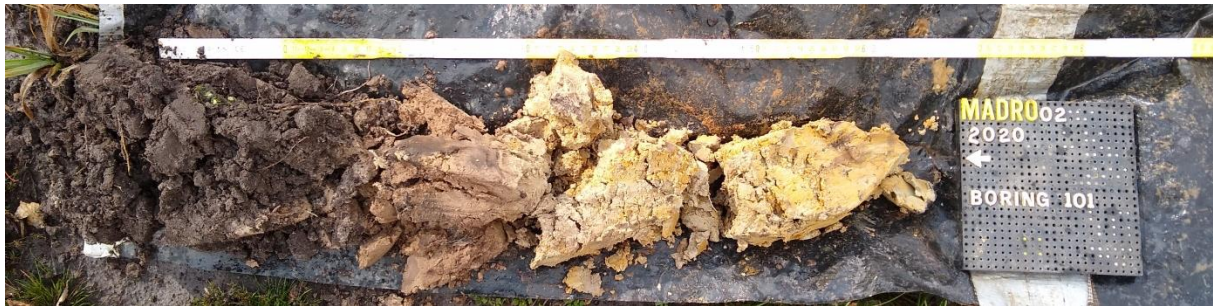
Figuur 17: Boring B101: Ap-A-C profiel, kleiig tertiair al vanaf 50 cm-mv.
