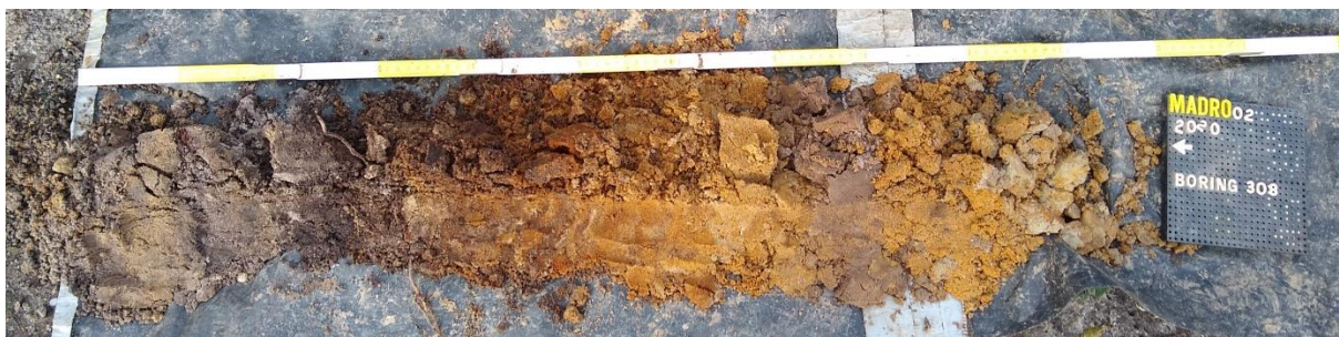
Figuur 19: Boring 308 met Ap-Bh-Bs-C profiel. Merk de gereduceerde Cr-horizont op (73-80 cm-mv) iets boven de start van de tertiaire klei (vanaf 95 cm-mv).
