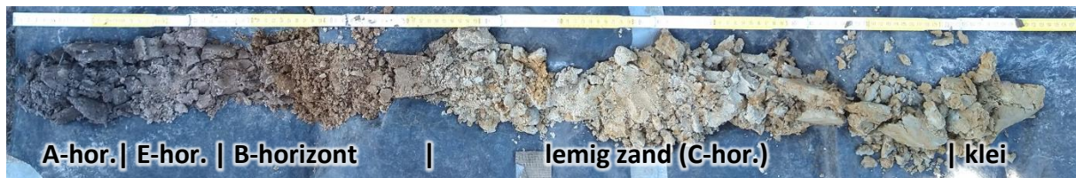
Figuur 11: Foto van boring 2, waarin een klein bodemprofiel zichtbaar is aan de top van het zand.
