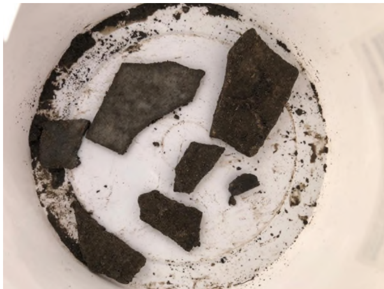
Sleuf C: visueel herkend asbestcement
