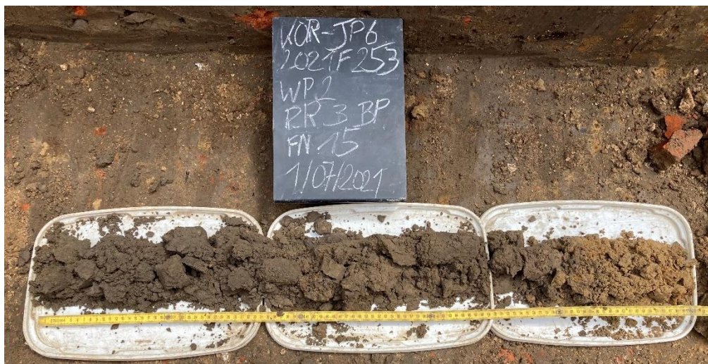
Figuur 31: Aanvullende boring bij profiel 3 in werkput 2
