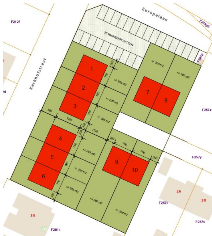
Figuur 5. Principetekening van de geplande verkaveling (bron: OG).
