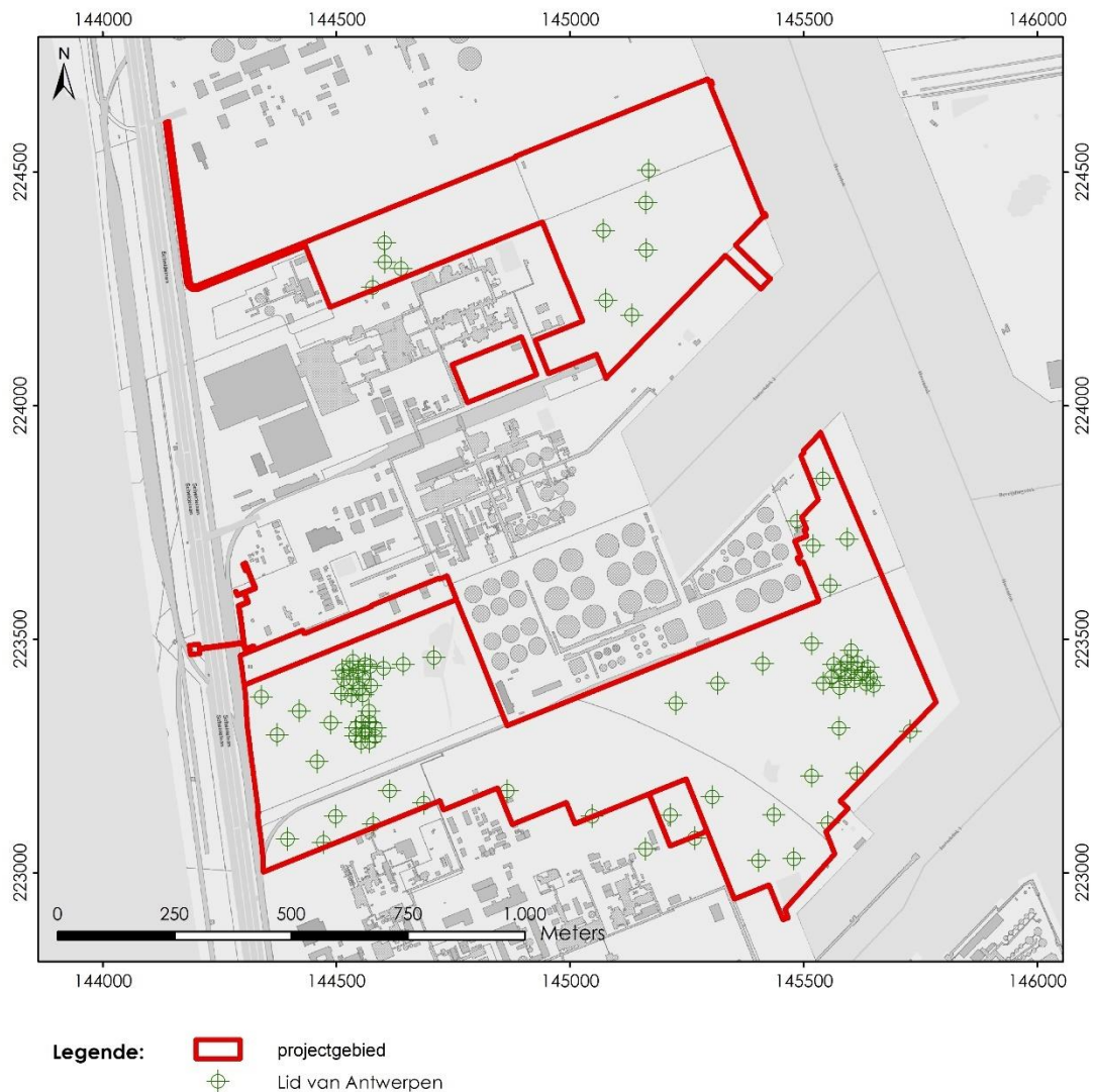
Figuur 31: Weergave van de sonderingen waar het Lid van Antwerpen kon geobserveerd worden.
