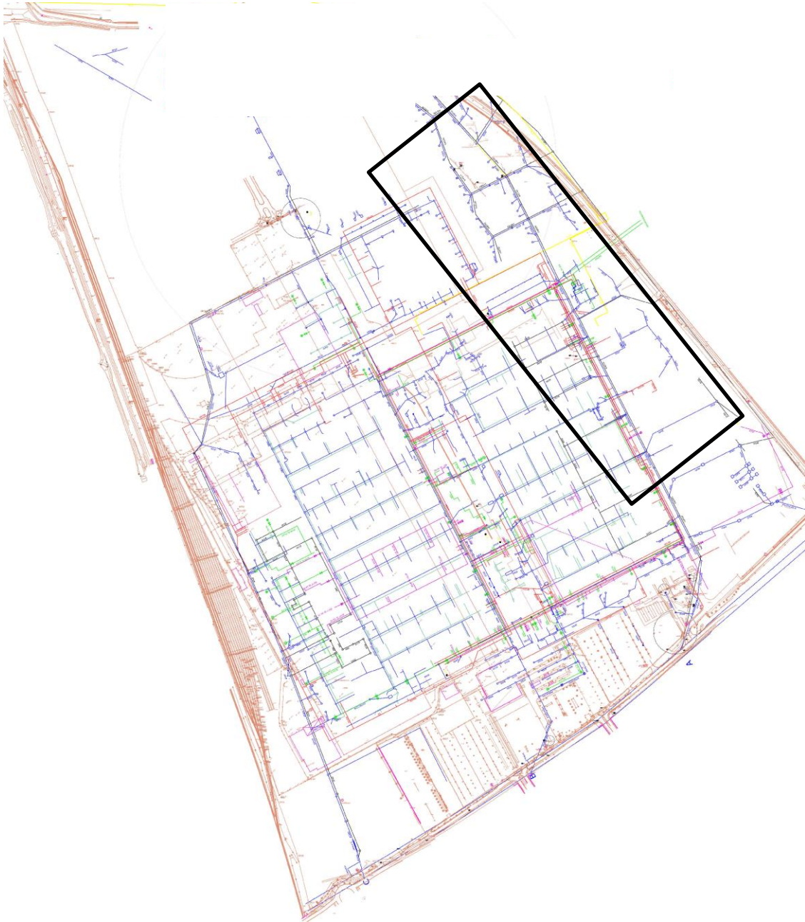
Figuur 10: Schematisch overzicht van het bestaand drainagesysteem op de site van Ford Genk met aanduiding van de locatie van het onderzoeksgebied (zwart). (Bron: Opdrachtgever, 2020).
