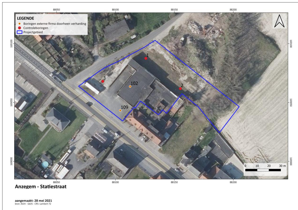
Figuur 27: Locatie controleboringen
