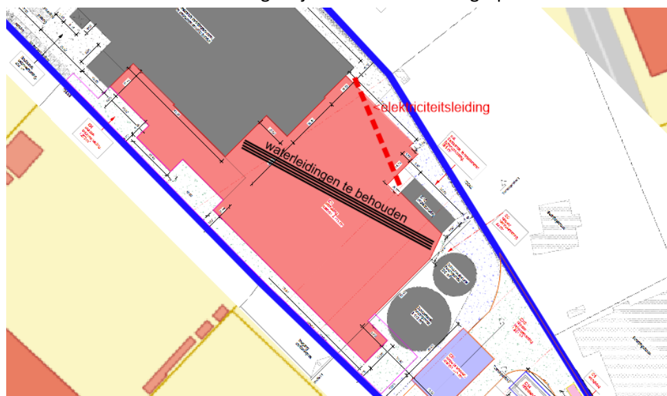
Fig. 1: Situering van de waterleidingen en de elektriciteitskabel
