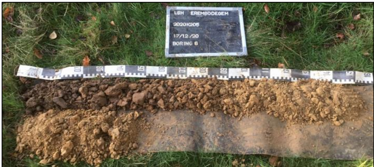
Figuur 8 Zicht op de boorkolom ter hoogte van boorpunt 6 met A-B-C profiel (Bron: Geosonda nv., 2020.).
