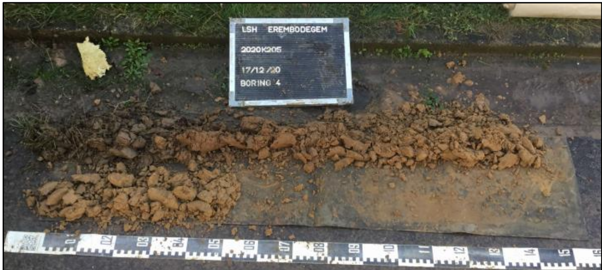
Figuur 7 Zicht op de boorkolom ter hoogte van boorpunt 4 met A-B-C profiel (Bron: Geosonda nv., 2020.).
