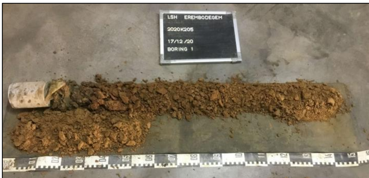
Figuur 6 Zicht op de boorkolom ter hoogte van boorpunt 1 met verstoring van de B-horizont (Bron: Geosonda nv., 2020.).
