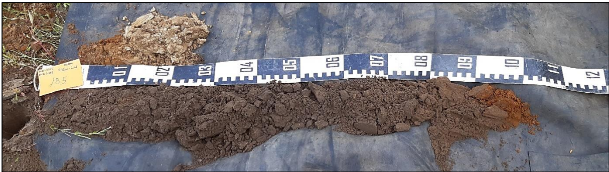
Figuur 9: Boring 5 van 0 cm (linksonder) tot 130 cm (rechtsboven) onder het maaiveld.
