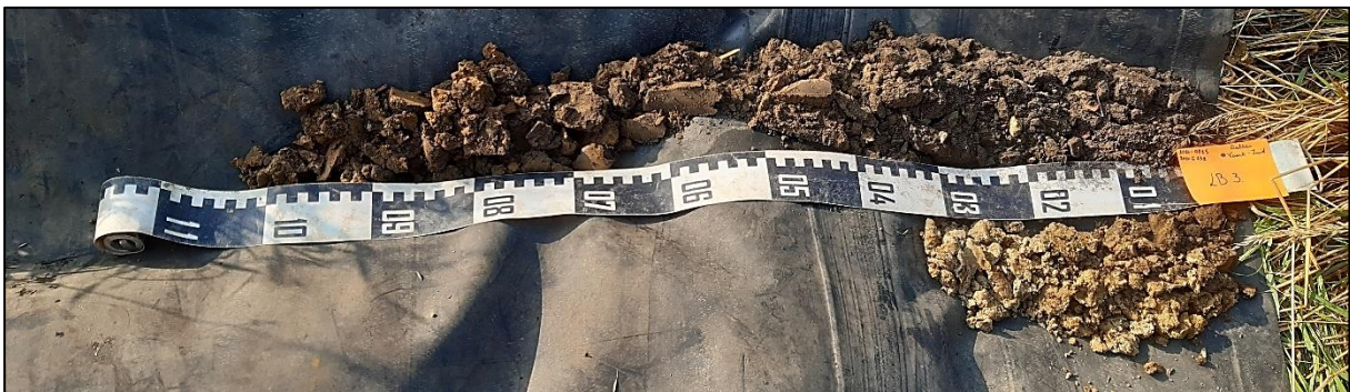
Figuur 7: Boring 3 van 0 cm (rechtsboven) tot 130 cm (linksonder) onder het maaiveld.
