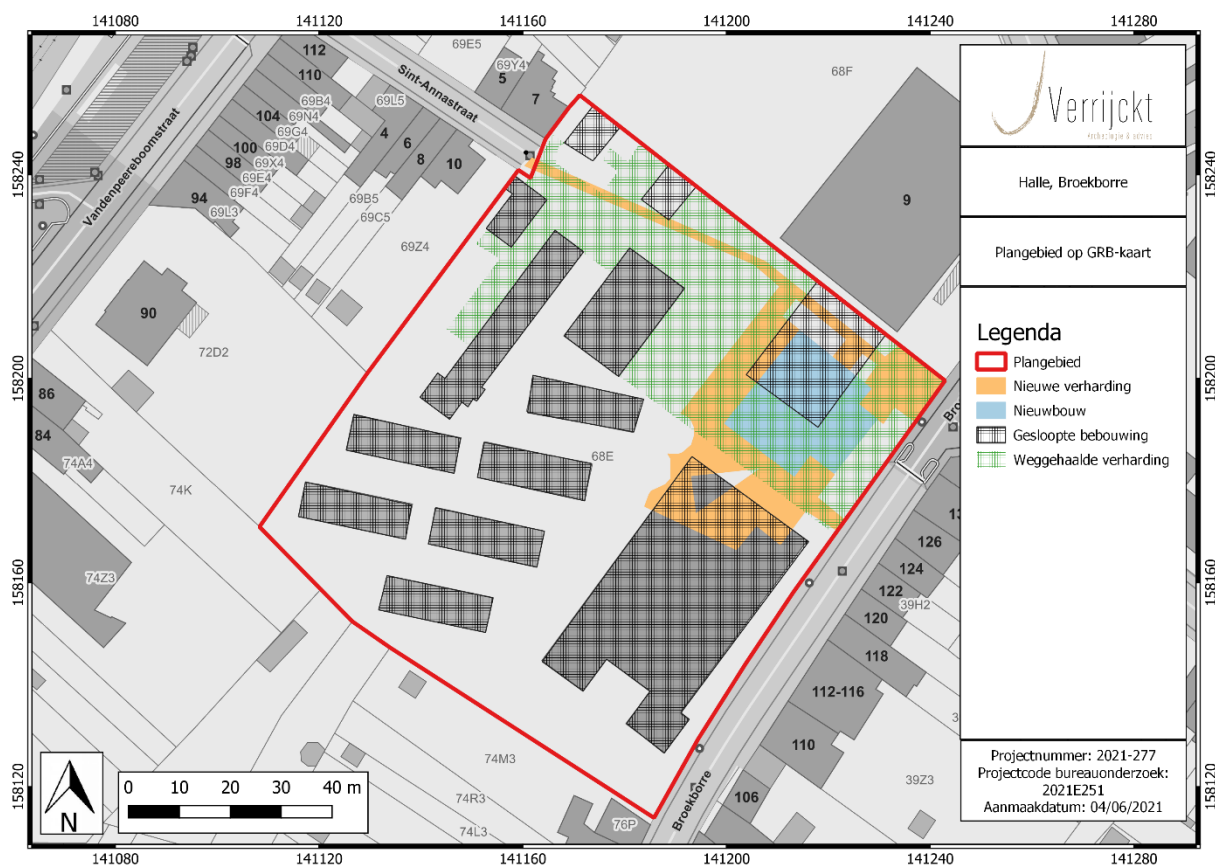
Figuur 29: Synthesepan van de geplande werken met situatie bebouwing 2015 op kadastrale kaart (GRB) 32
