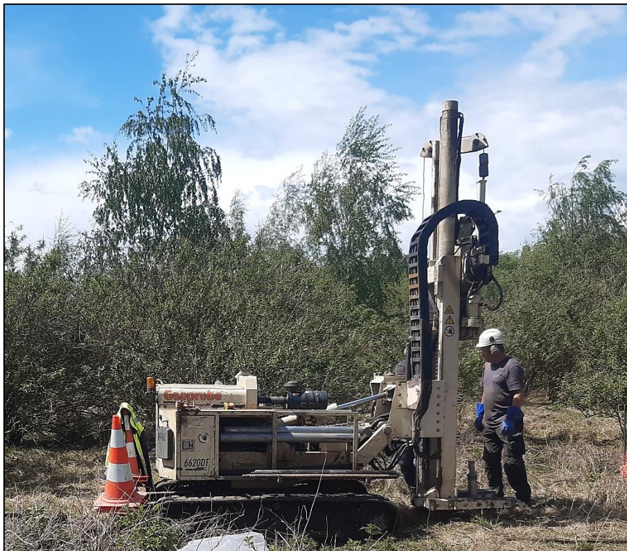
Figuur 2: Geoprobe model 6620 DT gebruikt voor het uitvoeren van de landschappelijke boringen.
