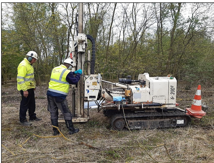
Figuur 4: Voorbeeld van het uitvoeren van de landschappelijke boringen.
