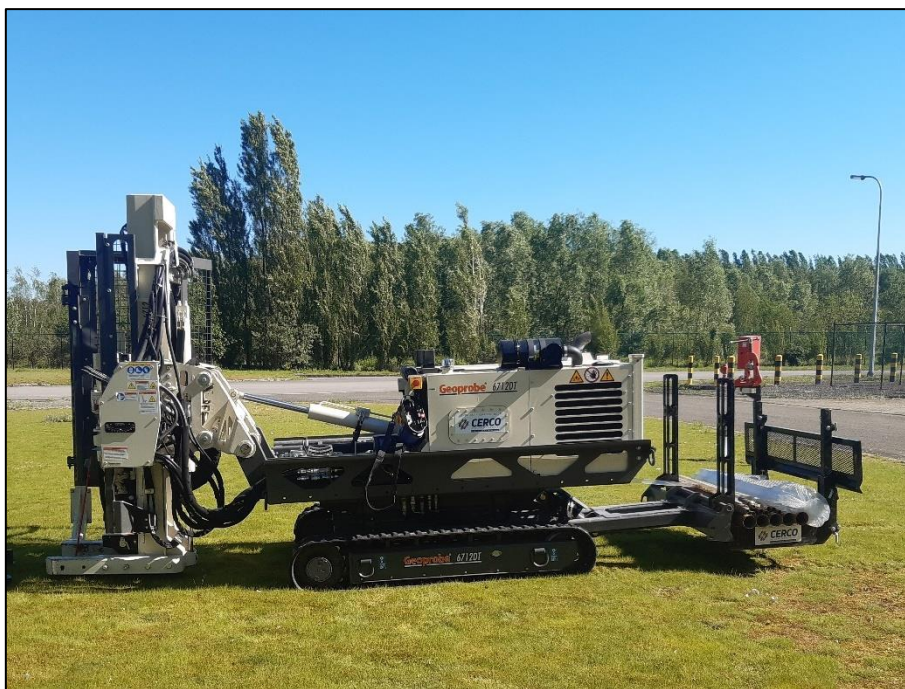
Figuur 3: Geoprobe model 6712 DT gebruikt voor het uitvoeren van de landschappelijke boringen.
