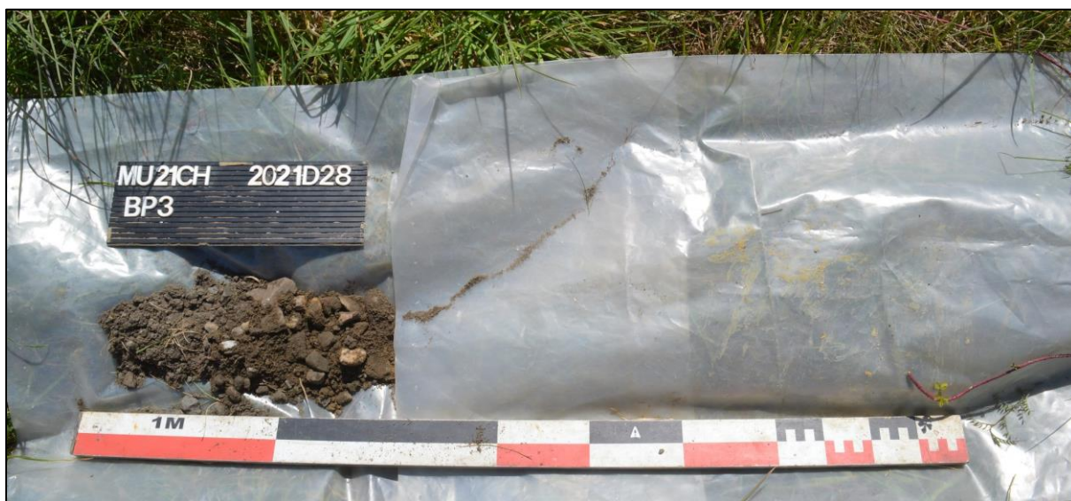
Afb. 24: Referentieprofiel B3 met aanwezige verstoring. Door puin kon hier niet dieper worden geboord. (Bron: ARON bv, dd. 28/04/2021, 2021D281).
