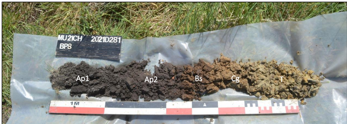
Afb. 20: Boorprofiel B8 met aanduiding van horizonten Ap1-Ap2- Bs-C-T (Bron: ARON bv, dd. 28/04/2021, 2021D281).
