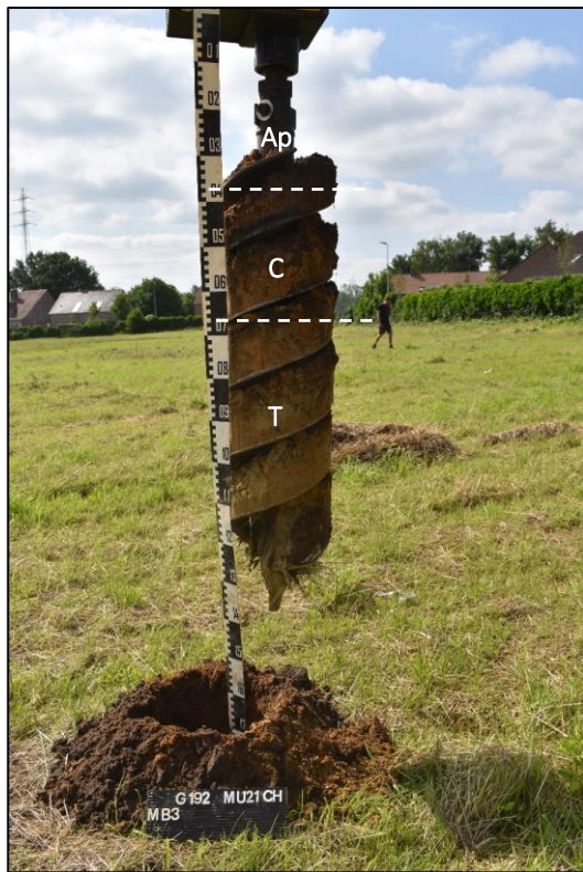
Afb. 32 (links): Referentieprofiel MB 3 met horizonten Ap – C – T (Bron: ARON bv, dd. 19/07/2021, 2021G192).
