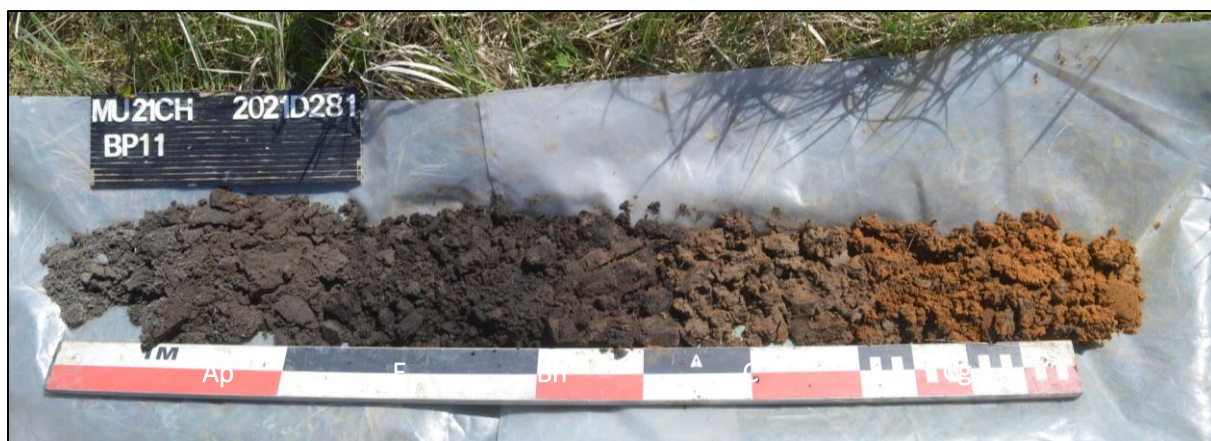
Afb. 18: Referentieprofiel B11 met aanduiding van horizonten Ap-E-Bh-C (Bron: ARON bv, dd. 28/04/2021, 2021D281).
