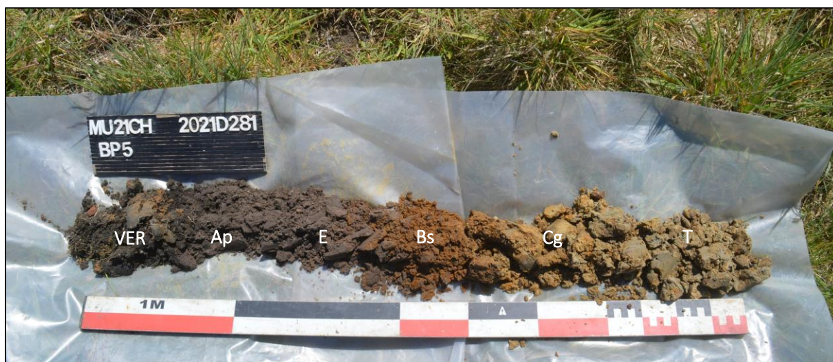
Afb. 19: Boorprofiel B5 met aanduiding van horizonten Ver-Ap-E-Bs-Cg-T (Bron: ARON bv, dd. 28/04/2021, 2021D281).
