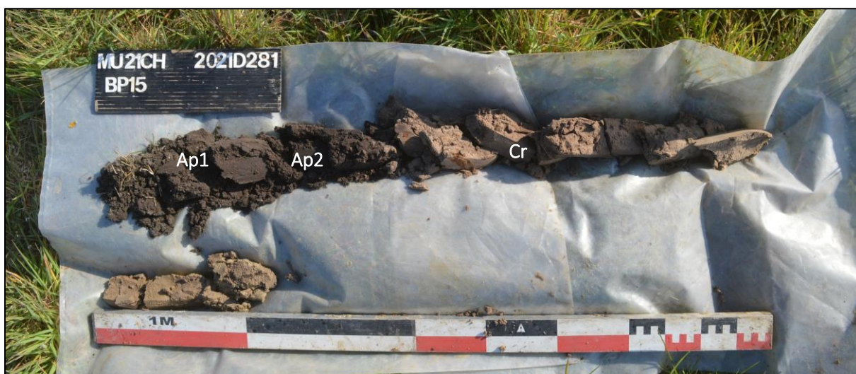
Afb. 23: Boorprofiel B15 met aanduiding van horizonten Ap1-Ap2- Cr (Bron: ARON bv, dd. 28/04/2021, 2021D281).
