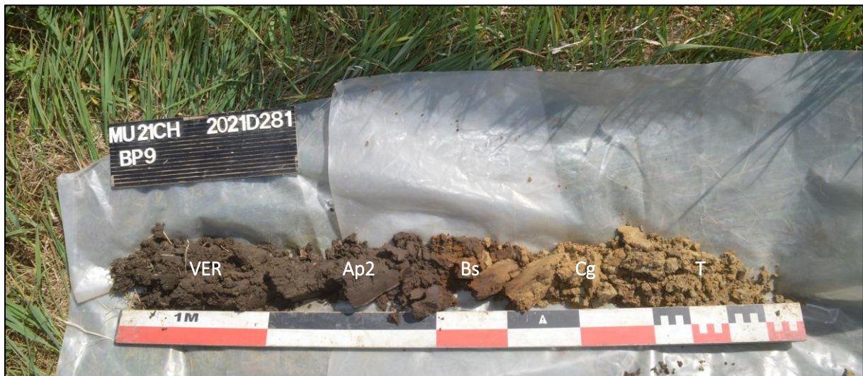
Afb. 21: Referentieprofiel B9 met aanduiding van horizonten VER-Ap2- Bs-C-T (Bron: ARON bv, dd. 28/04/2021, 2021D281).
