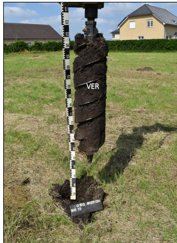
Afb. 32 (links): Referentieprofiel MB 3 met horizonten Ap – C – T (Bron: ARON bv, dd. 19/07/2021, 2021G192).
