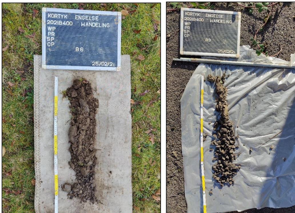
Figuur 52: Boorprofielen van gestaakte boringen 6 en 3 (ABO nv 2021).
