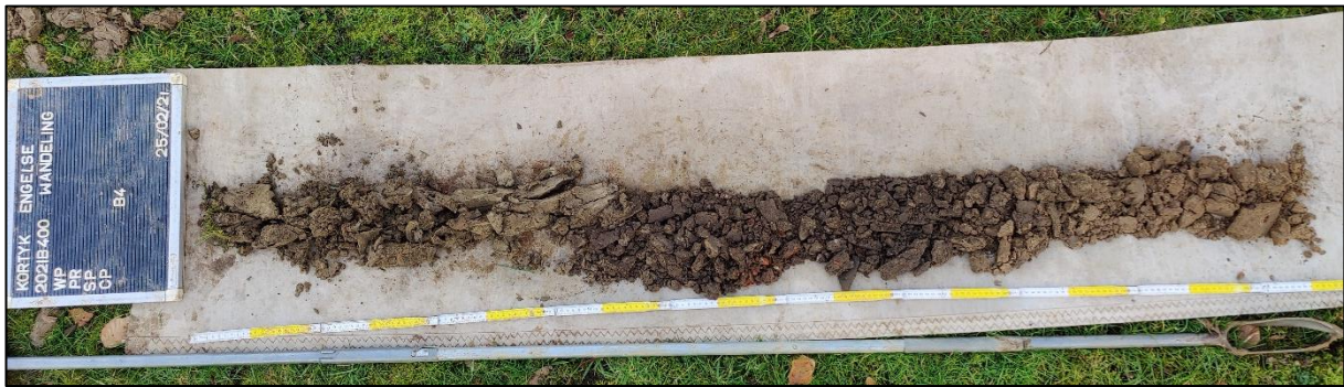
Figuur 51: Boorprofiel van boring 4, met onder de Aan-horizont een colluviaal (donker bruin) pakket dat de C-horizont (klei) afdekt (ABO nv 2021).
