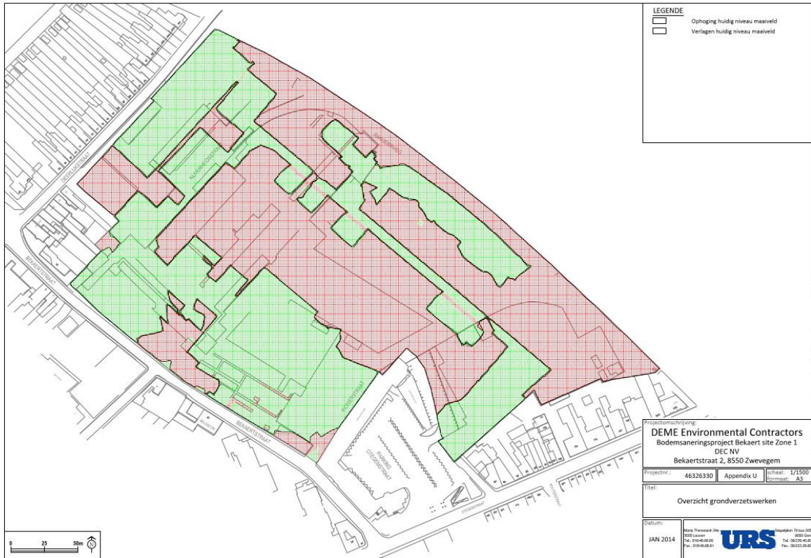
Figuur 4: overzicht ophoging en afgraving ten behoeve van de bodemsanering. Rood is ophoging huidig maaiveld, groen verlaging. Oorspronkelijk plan in bijlage 7
