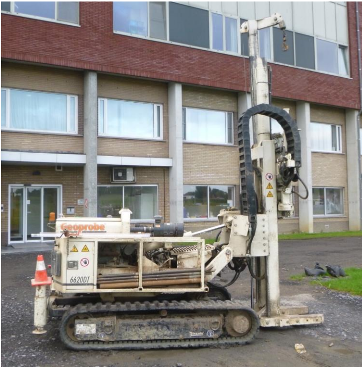
Figuur 28: Zij aanzicht van de mechanische boormachine (Geoprobe) die gebruikt werd tijdens dit onderzoek.
