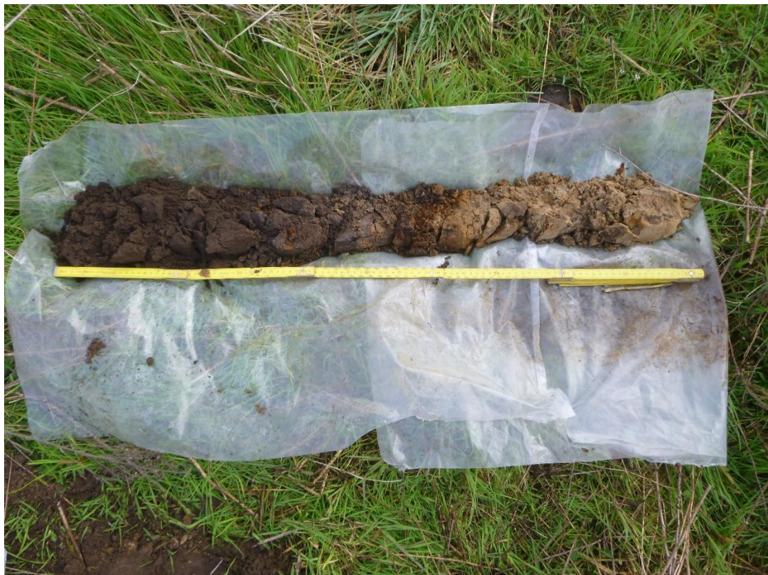
Figuur 5: Overzichtsfoto van VAB53 met sporen van uitloging en een ijzeraanrijkhshorizont. Het sediment is uitgelegd van links naar rechts.
