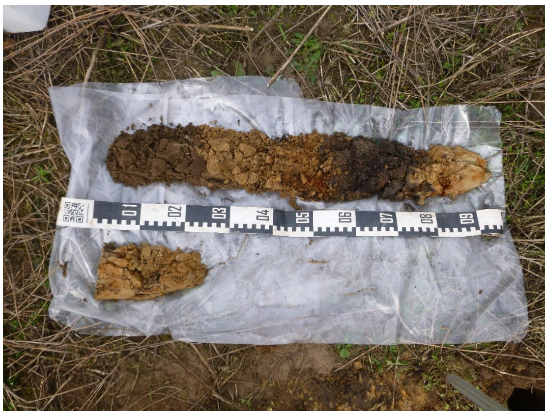
Figuur 7: Overzichtsfoto van VAB19 met een begraven A-horizont. Het sediment is uitgelegd van links naar rechts en van boven naar onder.
