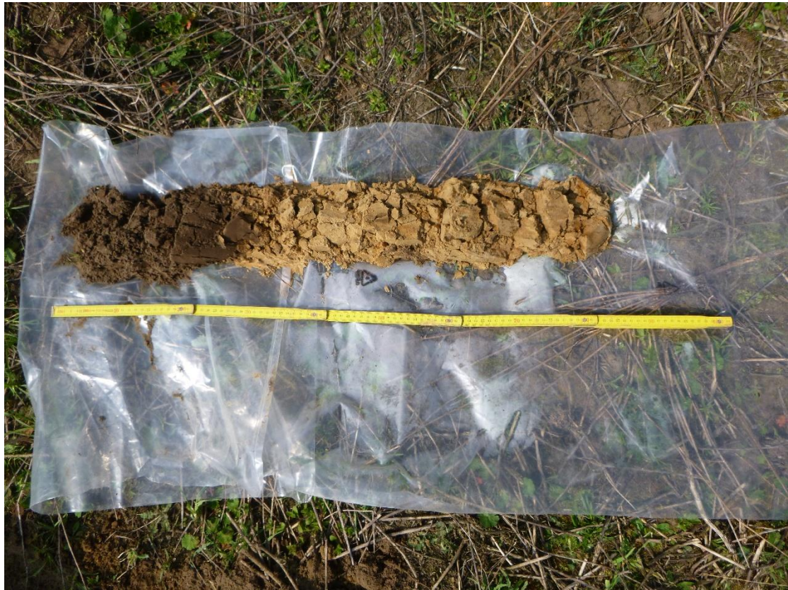
Figuur 8: Overzichtsfoto van VAB23, met een A-C bodemprofiel. Het sediment is uitgelegd van links naar rechts.
